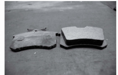
Abgefahrener & neuer Bremsbelag
